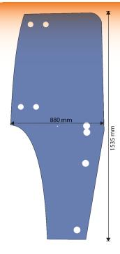
PLEASE MAKE SURE WHEN FITTING THE DOOR GLASS THAT THE HINGE MARKED TOP IS RETURNED TO THE TOP POSITION AND THE HINGE MARKED BOTTOM IS RETURNED TO THE BOTTOM POSITION. OTHERWISE THE GLASS WILL BREAK ON CLOSING.
